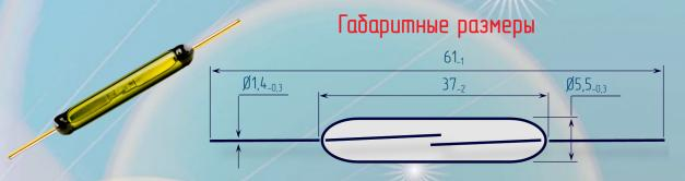
Указаны максимальные значения коммутириемых тока и напряжения. Произведение тока и напряжения рабочего режима не должно превышать значения коммутируемой мощности.
