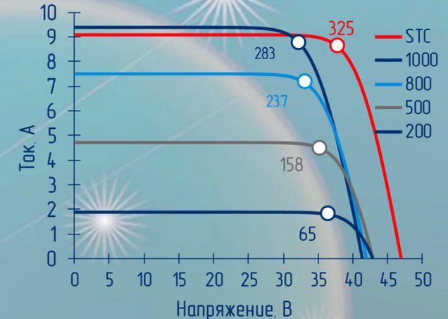
Кривые — при реальной температуре модуля в зависимости от облученности Вт/м<sup>2</sup> (температура воздуха 20°C)
