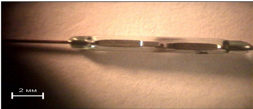
Рис. 7. Геркон после 100-кратной ионно-плазменной обработки
