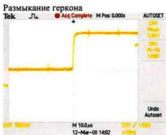
Рис. 2. Осциллограммы, иллюстрирующие срабатывание герконового датчика
